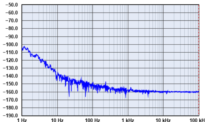
SLA36-30相位噪声测试曲线
