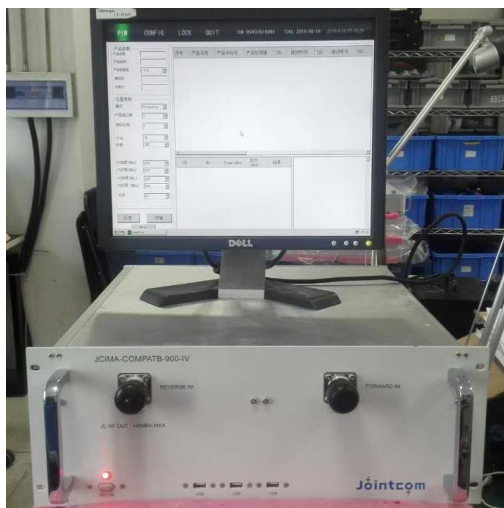
主机模块，包含主板/信号源/频谱仪/双工器等
